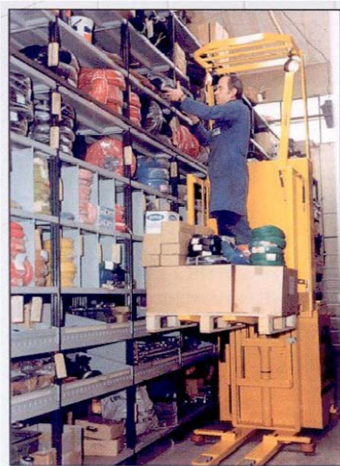
L'operatore gira per il magazzino con una lista di prelievo (*picking list*) relativa ad un ordine. Il “picker”, quando arriva in prossimità di un prodotto da prelevare, si ferma e lo preleva e lo deposita sul pallet che verrà, successivamente, controllato, confezionato e spedito.
