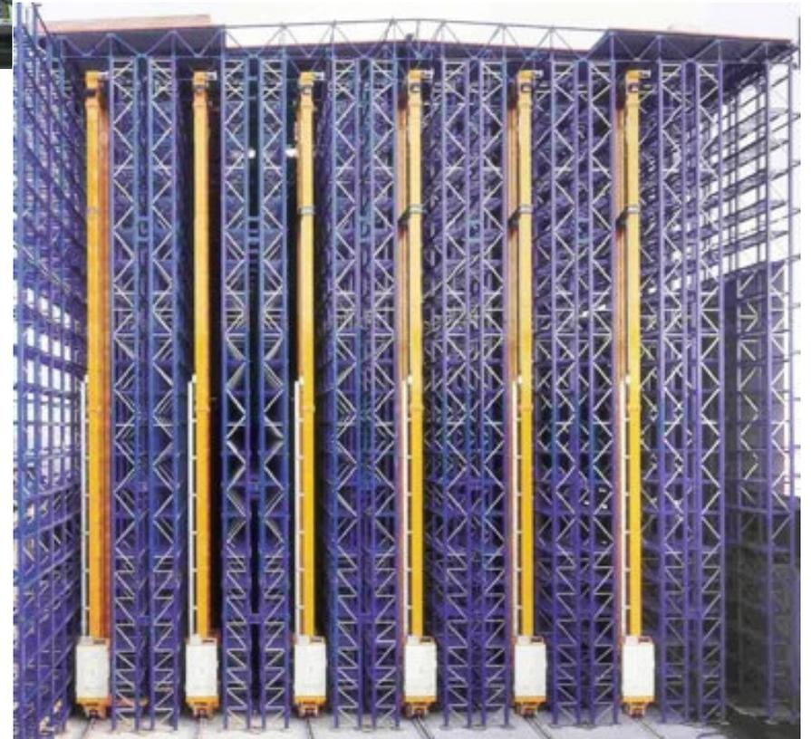
Il *trasloelevatore* è costituito da una *piattaforma* in grado di eseguire l'operazione di immissione o prelievo di un pallet (oppure di una cassa o di unità di carico di dimensione ridotte) . Il trasloelevatore scorre su una colonna che gli permette i movimenti in senso *verticale*, contemporaneamente questa colonna si muove *orizzontalmente* su dei binari.
