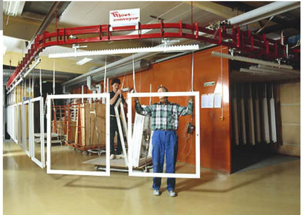
Questo tipo di trasportatori (convogliatori) permette di realizzare delle zone di accumulo e di stazionamento dei materiali in cui è presente solo la guida “free” e verso le quali le *bilancelle portacarichi* possono essere deviate anche manualmente.
