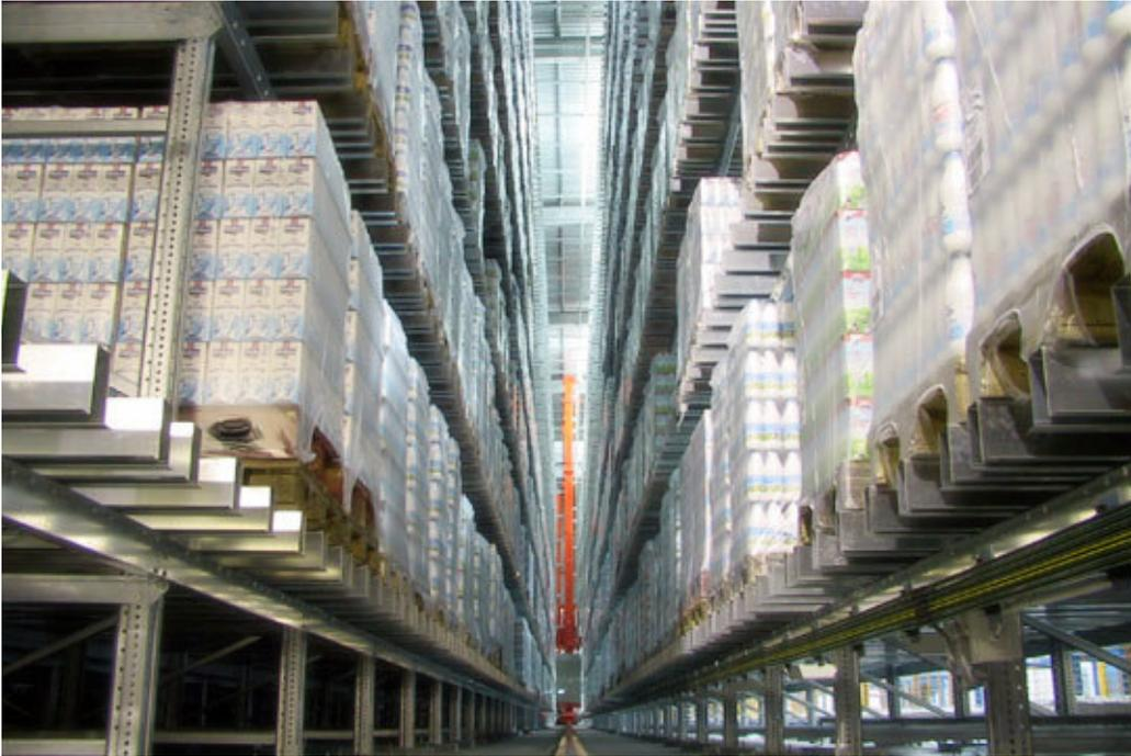
Si parla di magazzino “pesante” se le unità di carico che sono movimentate hanno peso superiore ai 500 kg.
